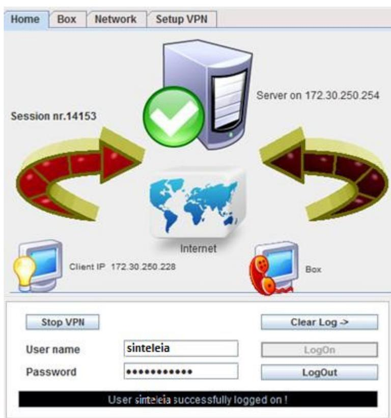
fig.3 – Finestra di login e start-stop della connessione VPN sul software BoxLinker
